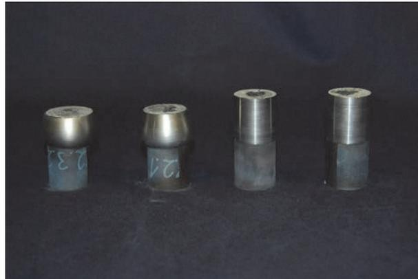
**Bild 2.3:** Diffusionsschweißverbindungen aus Stahl P91 (obere Probenhälfte) und Ti-45Al-5Nb-0.2C-0.2B (TNB) (untere Probenhälfte) Der Schweißdruck betrug 60 MPa, die Haltezeit 45 Min.; die Reihenfolge der hier gezeigten Verbindungen von links nach rechts entspricht den Temperaturen von 950 °C, 900 °C, 850 °C und 800 °C (Vorarbeit).
